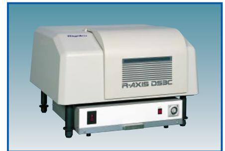
Imaging plate reader R-AXIS DS3C
