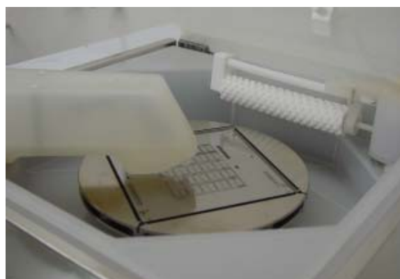
Очистка задней стороны фотошаблона, покрытого плёнкой (пелликлом)
