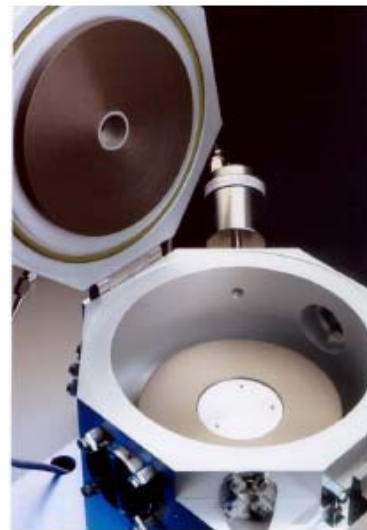
Система RIE-травления, с окошком, расположенным в центре газораспределительной крышки
